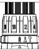
**N.B. :** Le chiffre sélectionné sur la bague de réglage du couple n'a aucun effet sur le fonctionnement de la perceuse tournevis en mode perçage.
