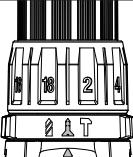
Bien réglé, l'embrayage réglable glisse à un couple prétréglé pour éviter de visser trop profondément dans différents matériaux et pour éviter d'endommager la vis ou l'outil.
