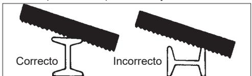
3. Coloque el apoyo de trabajo contra la pieza en la que se está trabajando y baje la segueta de la sierra en movimiento hacia el corte.
